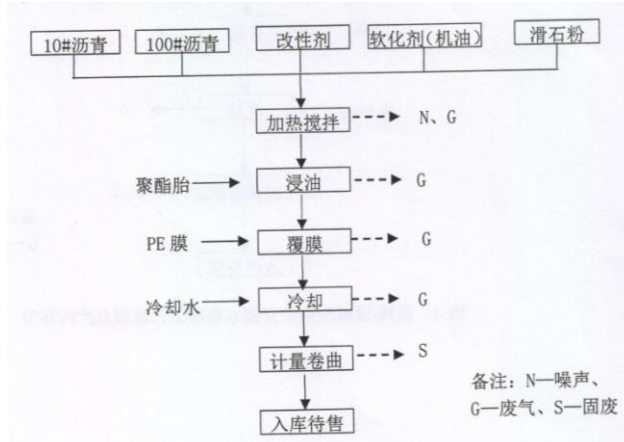
图 2-4 弹性体/塑性体改性沥青防水卷材工艺流程及产污环节图生产工艺流程简要说明:
